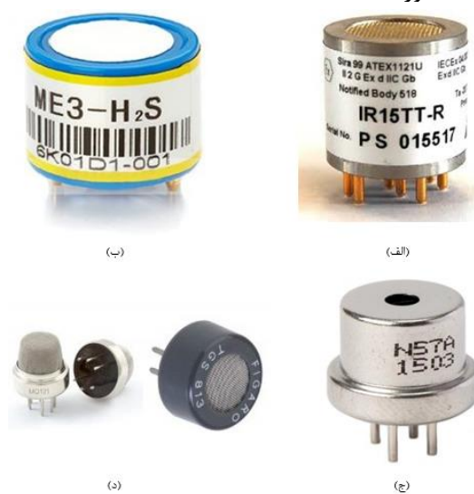
شکل ۱. سنسورهای آشکارساز گاز: الف) IR، ب) الکتروشیمیایی، ج) کاتالیستی، د) نیمه‌هادی
